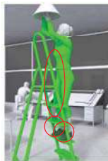
รูปที่ 4: ตัวอย่างที่จำเป็นของใช้สองมือแบบอิสระในระยะเวลาสั้นๆ สำหรับการทำงานเบาๆ เท้าทั้งสองข้างต้องยึดอยู่บนบันไดเช่นเดียวกับและร่างกาย (หัวเข่าหรือหน้าอก) ต้องถูกรองรับด้วยบันไดทรง A เพื่อรักษาสองจุดสัมผัส
