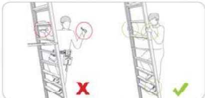
รูปที่ 2: ไม่ถือเครื่องมือ และ วัสดุด้วยมือ และควรเก็บถือในการปีนเครื่องขึ้น หรือ กระบี่ด้านข้าง (ซ้าย) ใช้หลัก three points of contact (ขวา)
