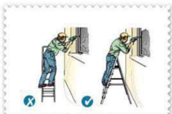
รูปที่ 5: ไม่ถูกต้อง - หันด้านข้างตัวเข้าทำงาน (ซ้าย) ถูกต้อง - หันตัวเข้าทำงาน (ขวา)
