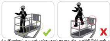
รูปที่ 6: วิธีการที่ถูกต้องของการทำงานในกระเช้า (MEWP) (ซ้าย) และปฏิบัติที่ไม่ปลอดภัย (ขวา)
