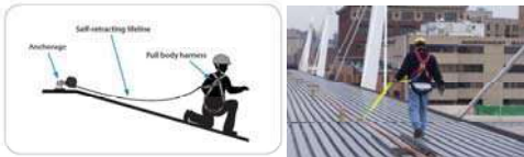
รูปที่ 8.3: ตัวอย่างของระบบการยับยั้งการตกส่วนบุคคลสำหรับงานบนหลังคา
